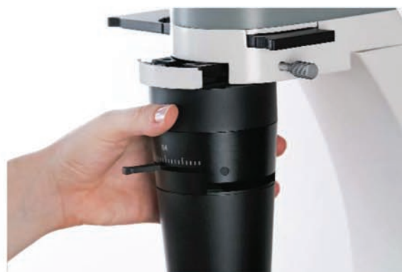
Увеличенное рабочее расстояние: легкое снятие конденсора, например, для роллерных инкубаторов.
