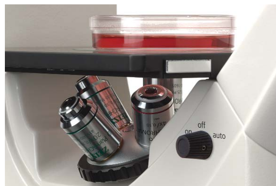
Легкость в использовании: режим автоматического отключения освещения и кнопка включения освещения на штативе обеспечивают удобную эксплуатацию микроскопа.
