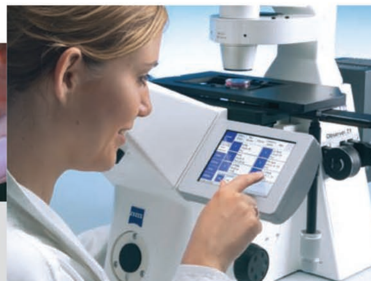
TFT-экран штатива или док-станции имеет удобное меню управления и конфигурирования
